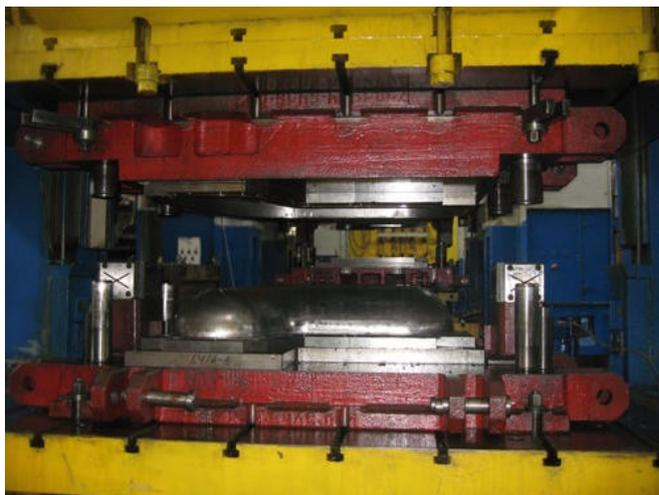
Операции листовой штамповки делятся на 2 группы: разделительные операции (резка, вырубка, пробивка) и формоизменяющие операции (гибка, вытяжка, отбортовка, обжим, формовка).
